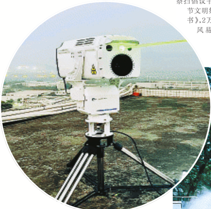
↑颗粒物激光雷达,射出一束激光束,大气污染强度变化尽收“眼底”。余果 供图
