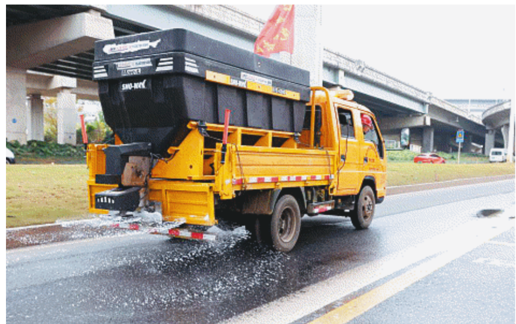
演练中，桥隧管理部门工作人员发现湘府路快速路花侯路上行匝道已“结冰”，迅速开展除冰撒盐。
