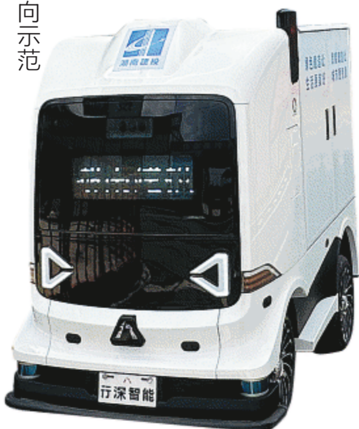
湖南建投岳麓山实验室集聚区农科院片区项目采用了智能无人车，其搭载北斗卫星导航系统，主要用于配送零星材料，最大可装载300公斤物料。
