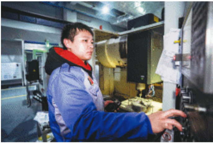
长沙先惠龙门加工设备可一次将长4米、宽3米的铝质汽车托盘加工成型。 易亿摄
