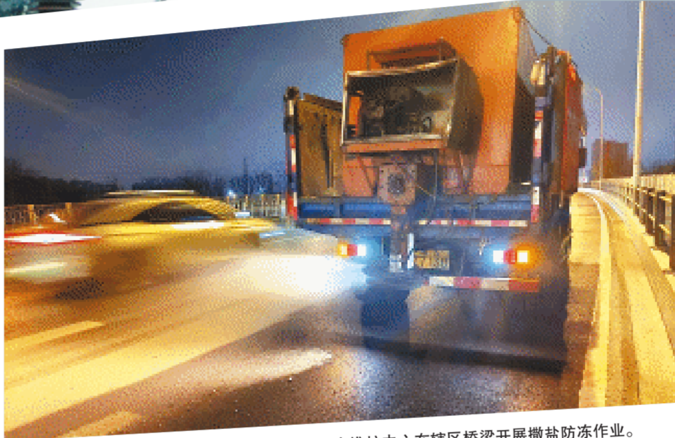
芙蓉区市容环境卫生维护中心在辖区桥梁开展撒盐防冻作业。长沙晚报通讯员 赵红武 供图
