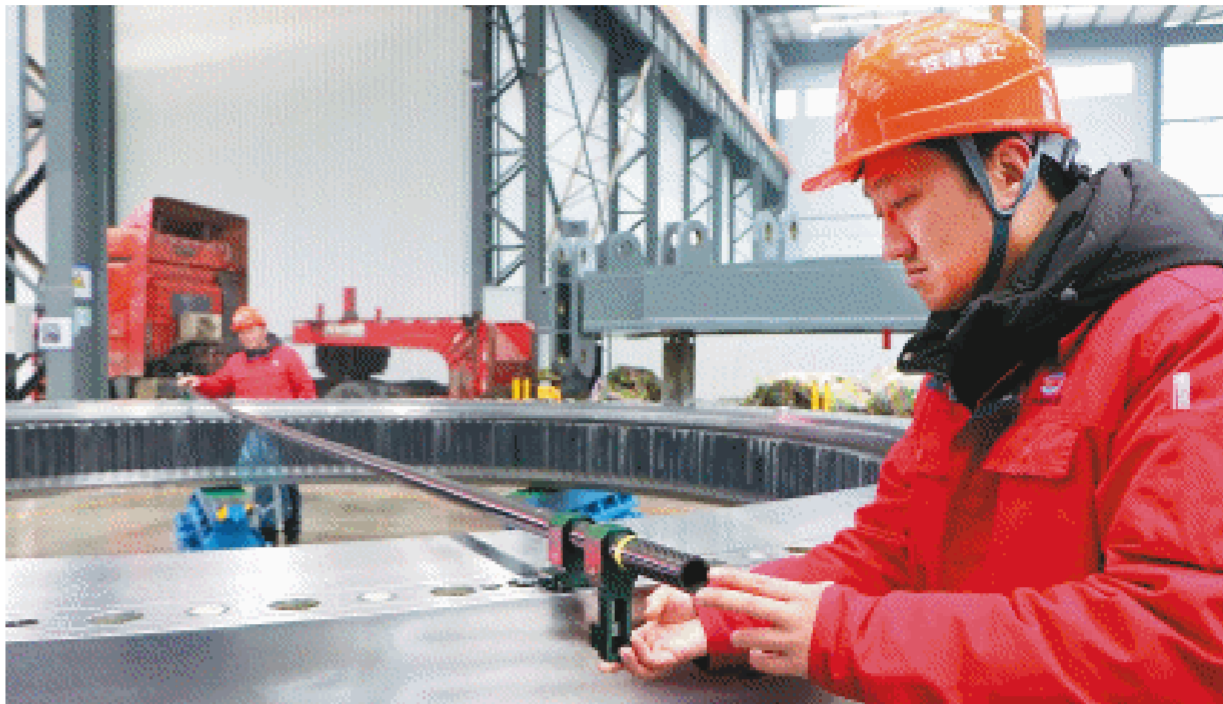
23日,铁建重工技术人员正在对某大直径泥水平衡盾构机进行整体尺寸检测复核。 长沙晚报通讯员 胡清 供图
