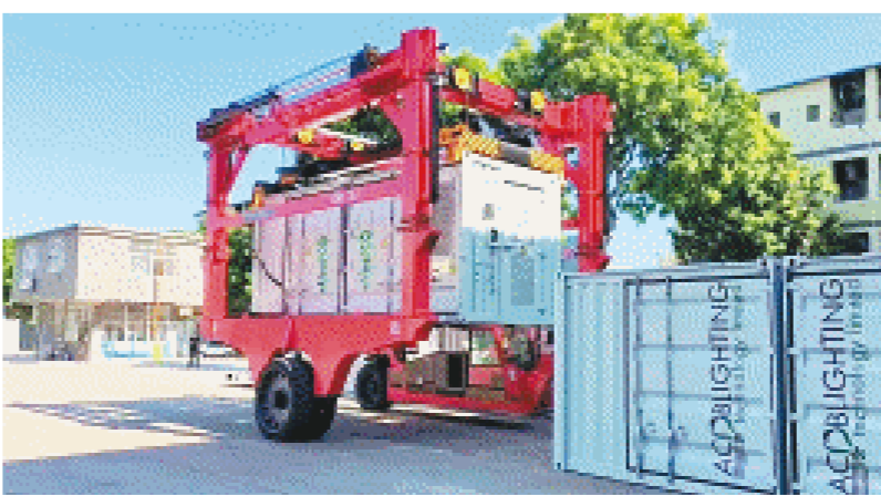
盛势通科技聚焦多式联运中的“散改集”问题，开发了国内首台集装箱卸车机。受访方供图
