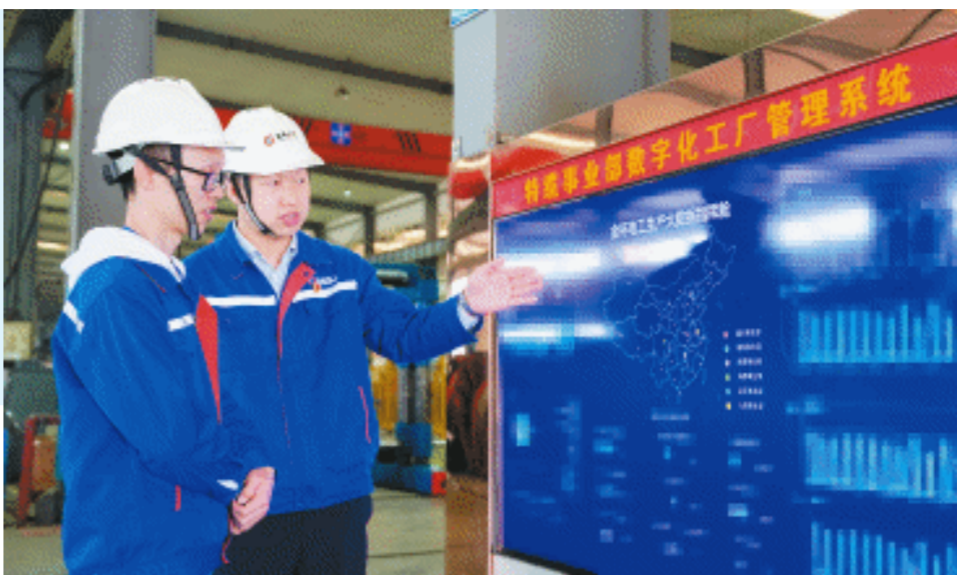
金杯电工的工厂内设有生产实况数据大屏,展示了车间生产的汇总数据,如产量产值数据、设备数据、能耗数据、库存数据等。长沙晚报全媒体记者 何文瑞 摄
