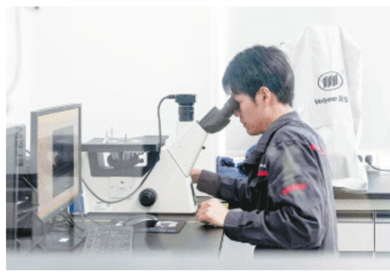
高创科惟研发中心,工作人员正在进行铜合金显微组织观察。长沙晚报全媒体记者 何文瑞 摄
