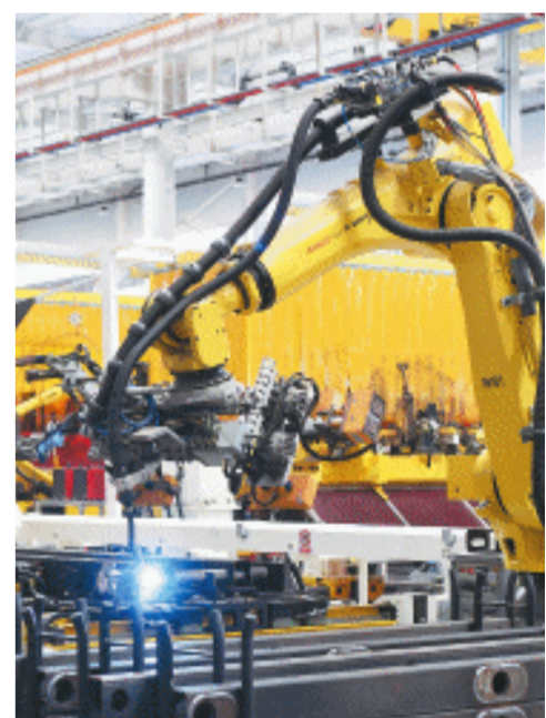
星邦智能的智能化生产车间内,机器人在进行自动焊接。长沙晚报全媒体记者 郭雨滴 摄
