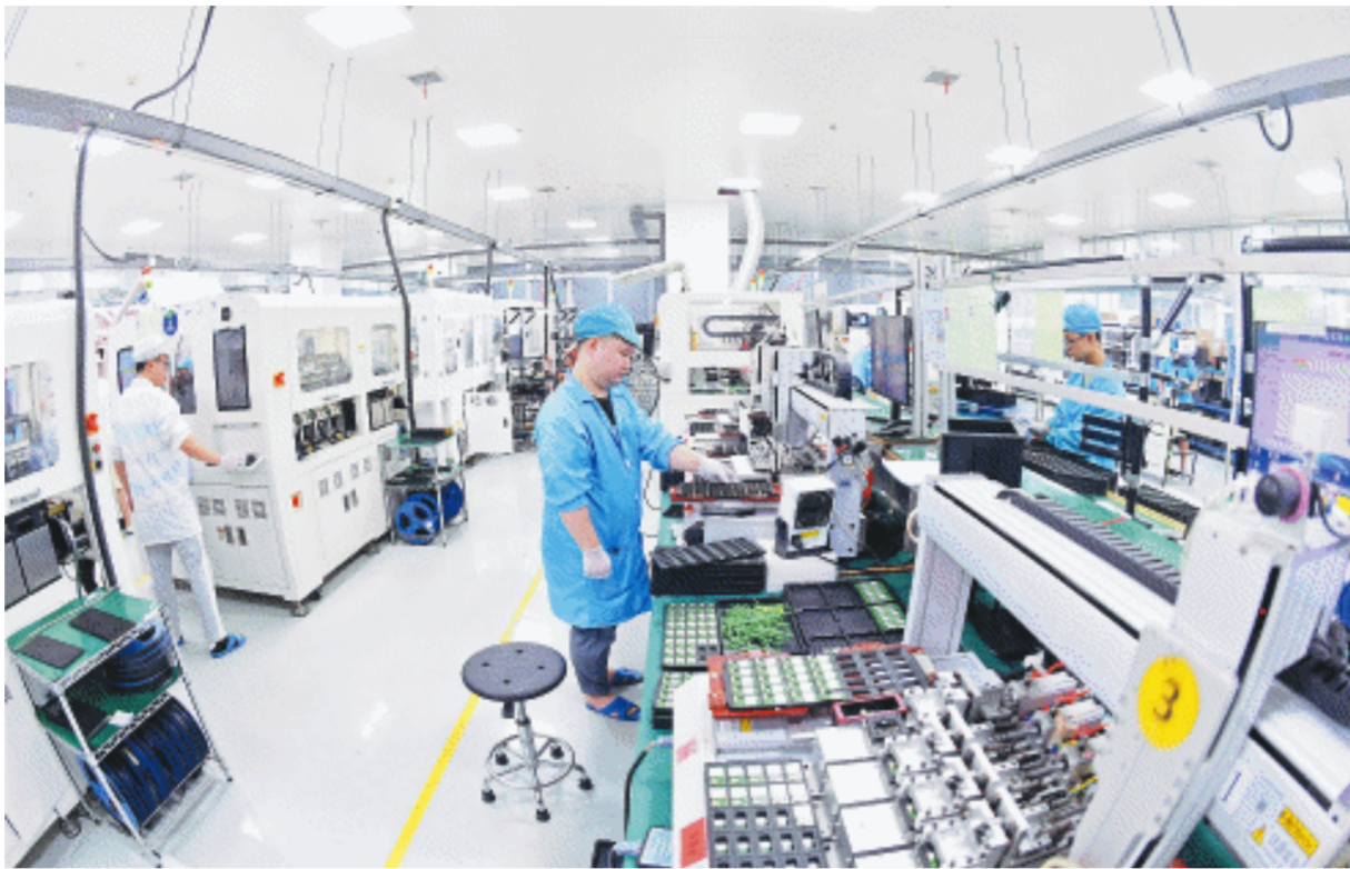
中龙通9条SMT产线能实现24小时连续作业，日产能可达20万片电路板。长沙晚报全媒体记者 王志伟 摄
