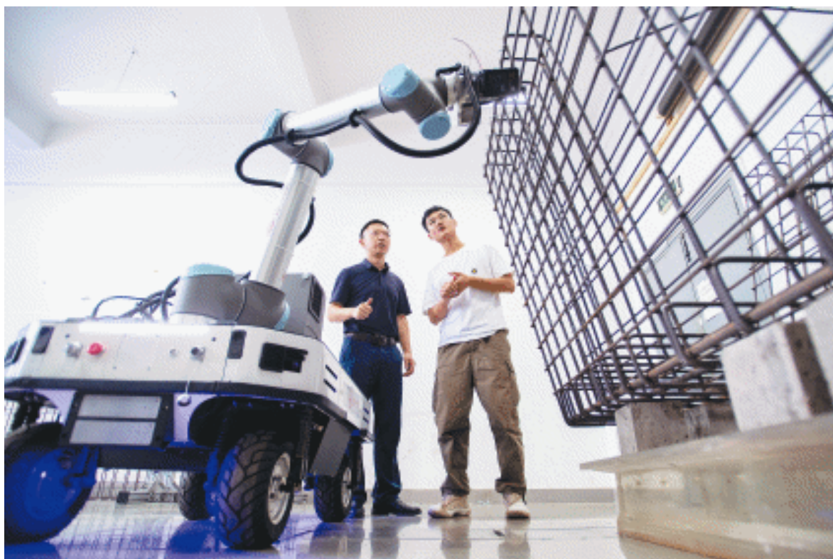
邓露(左)在指导学生调试实验室新研发的一台智能钢筋绑扎机器人。 长沙晚报全媒体记者 郭雨滴 摄
