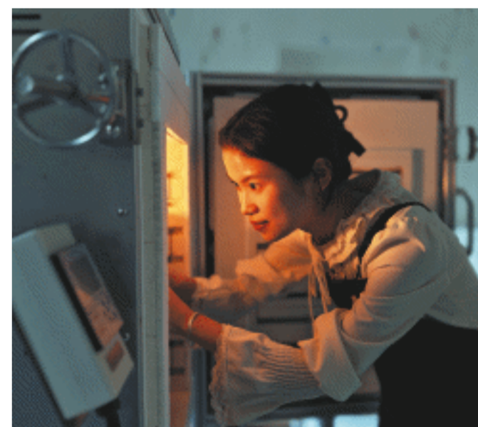
雷雨晴将灯工玻璃作品放入锅炉中加热进行退火处理。
