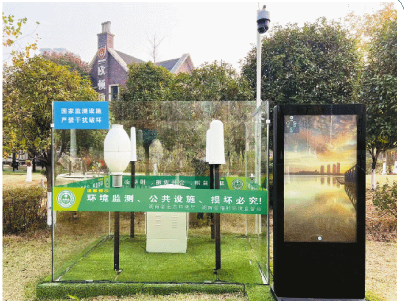
4座自动监测站分别是圭塘河公园站、马栏山公园站、鸭嘴公园站、西湖公园站。图为电磁辐射环境自动监测圭塘河公园站。
